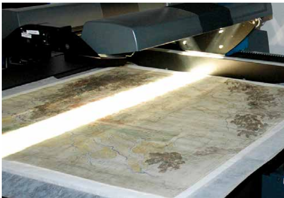
I2s Suprascan: scanner per esemplari di grande formato di Walter Nagel.
